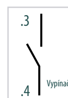
Označenie svoriek a funkcia vysokovýkonného výstražného spínača Kontakt NO
